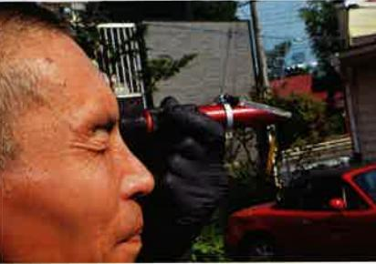
念入りに冷却系統の水分を取り除いた後、いよいよエバンスのウォーターレスクーラントを入れる。さらに作業の最後には、クーラントの中に水分がどの程度混入しているか濃度を計るために、専用の屈折計測器で計測するという念の入れよう。専門の取扱店ならではのきめ細かな作業だ。
