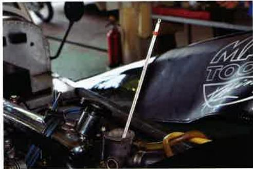
回っているエンジンの洗浄液の温度を計っている、の図。写真では見えづらいが、温度計の目盛りは91℃を指している。当然洗浄液も"無水"なので、全く沸騰する兆しはない。
