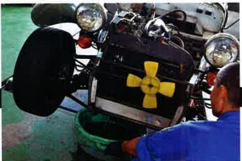
ファクトリーに入庫後、水温が下がって来た頃合いを見計らって、今まで入っていた通常のクーラントを抜く。ウチのセブンはラジエターにドレンコックが付いていないので、ロワーホースを外して排水。
