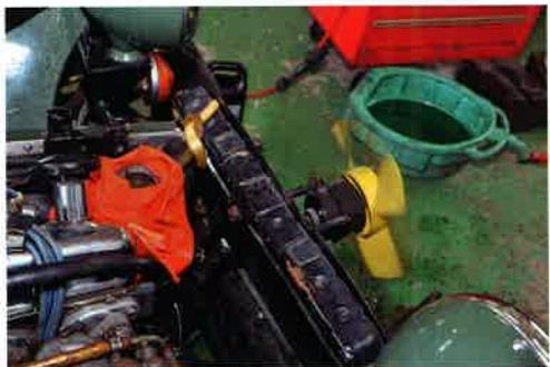
エンジンの暖気を行い、しばしの間洗浄液を循環。ラジエターキャップが付いていないのは締め忘れたわけではなく、電動ファンが作動する温度域になってしまっても、水蒸気を吹き上げる事が無いという"証拠写真"。
