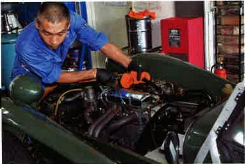
クーラントの排水が終わったら、さらにヒーター・ホースなども取り外し、水路に圧縮空気を吹き込んで、ホースやエンジン内部に残っている少量のクーラントも、可能な限り排出する。
