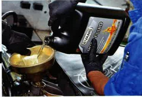
その後、いったん冷却系統のホース類を全て元に戻し、プレップフリードと呼ばれる専用の洗浄液を入れる。ご覧の通り、洗浄液は無色透明。
