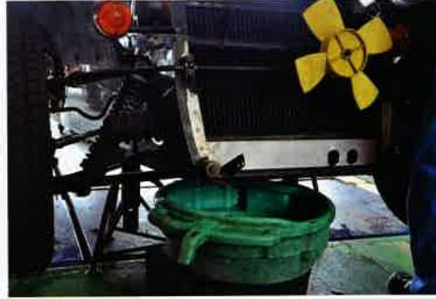
洗浄後、再びロワーホースを外して洗浄液を排出。もともと無色透明だった洗浄液は、僅かに緑がかっている。これは僅かに水路に残っていた、クーラントの残りと混ざった色。その後再び洗浄液を圧縮空気で吹き飛ばす。
